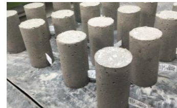
Figura 4- Corpos de prova já desmoldados
